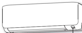
Кнопка ВКЛ/ВЫКЛ на приборе
