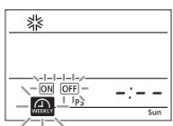
Когда установки (ON TIMER (таймер включения) или OFF TIMER (таймер выключения)) заданы, мигает индикатор таймера или .
