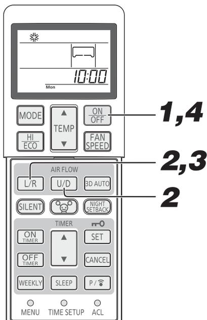
**1** Wenn das Gerät in Betrieb ist, drücken Sie zum Abschalten die ON/OFF-Taste.
