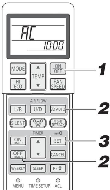
**1** Wenn das Gerät in Betrieb ist, drücken Sie zum Abschalten die ON/OFF-Taste.
