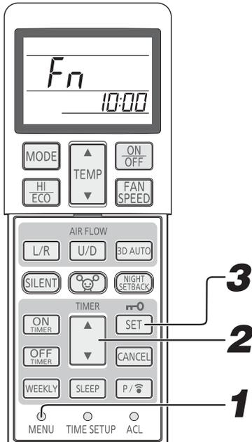
**1** Wählen Sie die Lüftersteuerung Heizen bei Thermo-OFF durch Drücken des MENU-Schalters.
