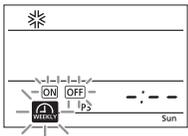
Когда установки (ON TIMER (таймер включения) или OFF TIMER (таймер выключения)) заданы, мигает индикатор таймера **ON** или **OFF**.
