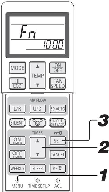
**1** Seleccione el Control ventilador corte termostato calor pulsando el interruptor MENU (MENÚ).
