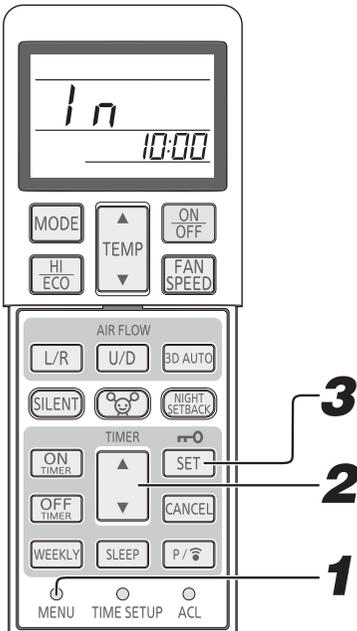
**1** Seleccione el Ajuste de comunicación de LAN inalámbrica pulsando el interruptor MENU (MENU).
