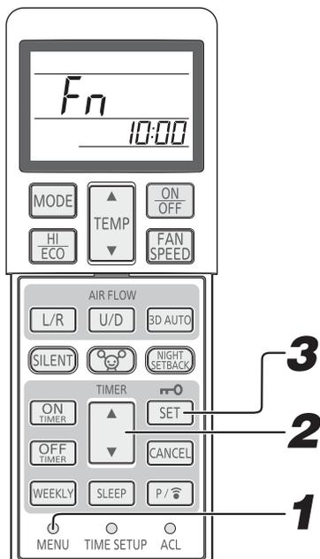
**1** Selezionare il Riscald. - Controllo vent. in OFF-termo premendo l'interruttore MENU.
