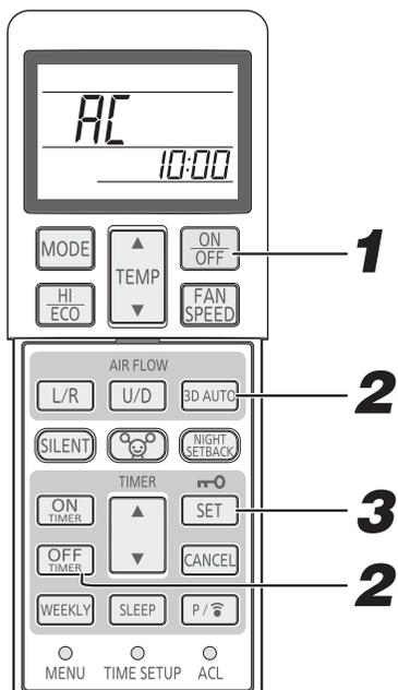
**1** Se il condizionatore è in funzione, arrestarlo premendo il tasto ON/OFF.
