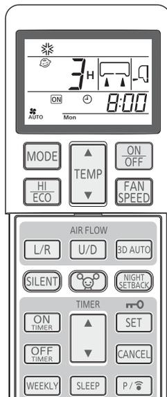
Esempio: Viene arrestato dopo 3 ore, e quindi si riavvia, essendo prossimo alla temperatura impostata per le 8:00.
