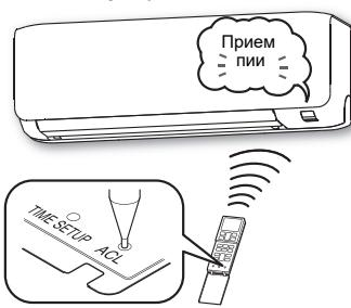
**3** Проследите за тем, чтобы зуммер приема во внутреннем модуле подал звуковой сигнал "пии".
