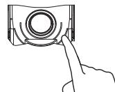
Отрегулируйте ориентацию датчика движения, нажав на край датчика.
