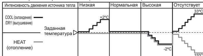
РЕЖИМ: работа в режиме COOL/HEAT/DRY (ОХЛАЖДЕНИЕ/ОБОГРЕВ/ОСУШЕНИЕ)
