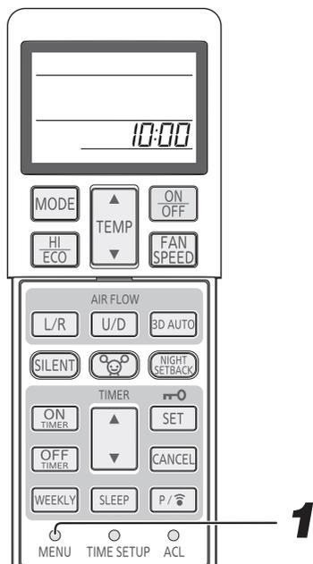
**1** À chaque appui sur la touche MENU avec l'extrémité d'un stylo à bille, etc., l'affichage bascule d'une fonction à l'autre :
