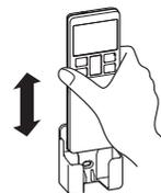
Pour sortir et remettre la télécommande, il suffit de la glisser le long du porte-télécommande.
