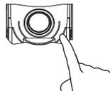
Regolare l'orientamento del sensore di movimento premendo l'estremità del sensore.
