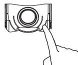
Ajuste a orientação do sensor de movimento pre-mindo a extremidade do sensor.
