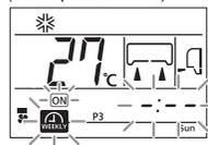
Выбран таймер OFF TIMER (таймер выключения)
