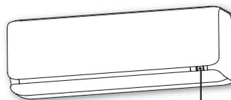
Кнопка ВКЛ/ВЫКЛ на приборе
