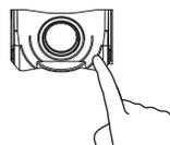
Отрегулируйте ориентацию датчика движения, нажав на край датчика.
