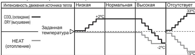
РЕЖИМ: работа в режиме COOL/HEAT/DRY (ОХЛАЖДЕНИЕ/ОБОГРЕВ/ОСУШЕНИЕ)
