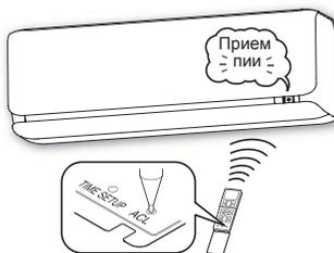
**3** Проследите за тем, чтобы зуммер приема во внутреннем модуле подал звуковой сигнал "пии".
