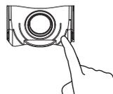
Réglez l'orientation du capteur de mouvement en appuyant sur l'extrémité de celui-ci.
