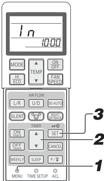
**1** Sélectionnez le réglage de la communication LAN sans fil en appuyant sur l'interrupteur MENU.
