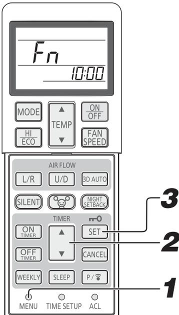
**1** Sélectionnez la fonction Régulation Ventilateur pour réchauffage à l'arrêt en appuyant sur l'interrupteur MENU.
