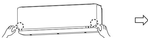
Удерживая нижние углы детали А, снимите крюк с основного корпуса.
