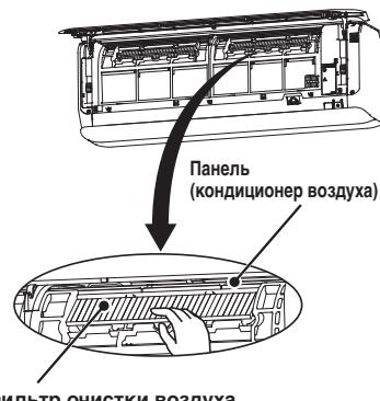
4. Установите воздушные фильтры и закройте панель воздухоприемника. Стр. 33
