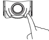
Ajuste la orientación del sensor de movimiento presionando el extremo del sensor.
