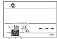
Cuando están disponibles los contenidos de ajuste (ON TIMER (Temporizador de encendido) u OFF TIMER (Temporizador de apagado)), el temporizador **ON** o **OFF** parpadea.
