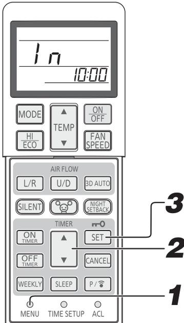
**1** Seleccione el Ajuste de comunicación de LAN inalámbrica pulsando el interruptor MENU (MENÚ).
