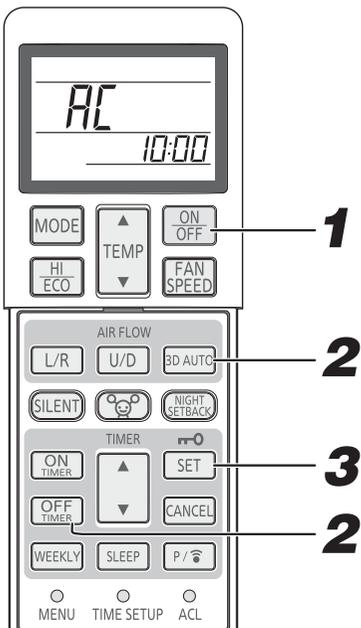
**1** Si el aire acondicionado está en funcionamiento, pulse el botón ON/OFF (ENCENDIDO/APAGADO) para detenerlo.
