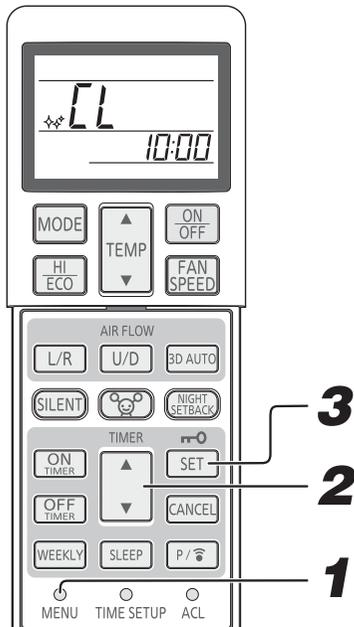
**1** Pulse el interruptor MENU (MENÚ) para seleccionar el modo de funcionamiento SELF CLEAN (autolimpeza).
