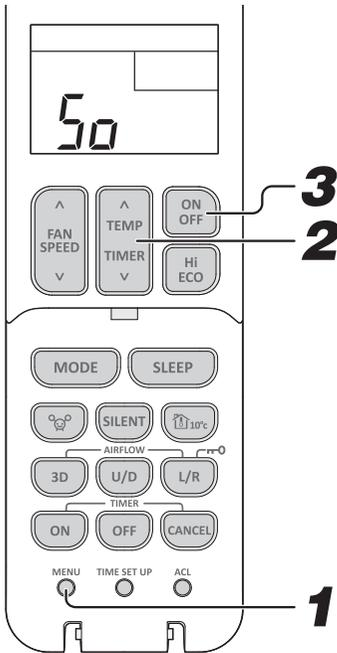
**1** Wählen Sie die Einstellung des SILENT-Modus durch Drücken des MENU-Schalters.
