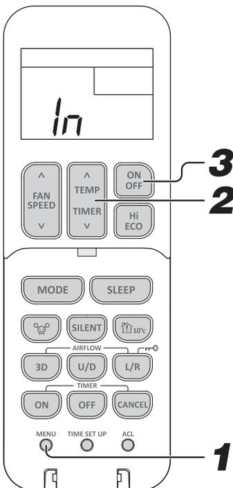
**1** Wählen Sie die Einstellung der WLAN-Kommunikation durch Drücken des MENU-Schalters.
