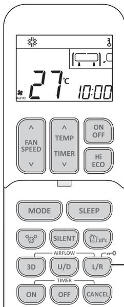
**1** Drücken Sie die AIRFLOW L/R (LEFT/RIGHT)-Taste 3 Sekunden oder länger.
