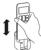
Para instalar o retirar el control remoto, deslice el mismo hacia arriba o hacia abajo desde la parte superior del soporte.
