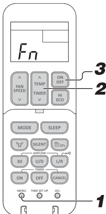
**1** Seleccione el Control ventilador corte termostato calor pulsando el interruptor MENU (MENU).
