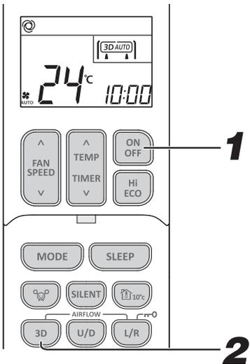
**1** Pulse el botón ON/OFF (ENCENDIDO/APAGADO).
