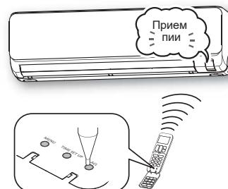
**3** Проследите за тем, чтобы зуммер приема во внутреннем модуле подал звуковой сигнал "пиши".
