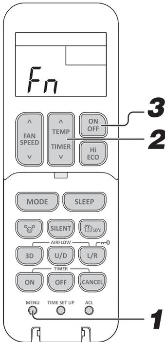
**1** Seleccione el Control ventilador corte termostato calor pulsando el interruptor MENU (MENÚ).
