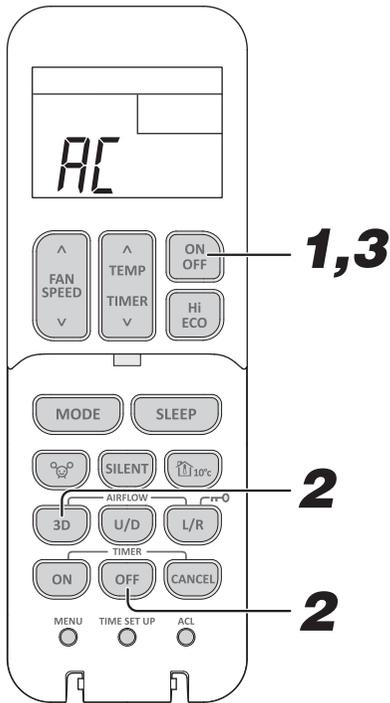
**1** Si el aire acondicionado está en funcionamiento, pulse el botón ON/OFF (ENCENDIDO/APAGADO) para detenerlo.
