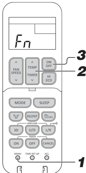
**1** Seleccione el Control ventilador corte termostato calor pulsando el interruptor MENU (MENÚ).
