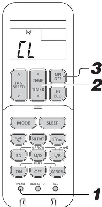
**1** Pulse el interruptor MENU (MENÚ) para seleccionar el modo de Funcionamiento SELF CLEAN (autolimpieza).
