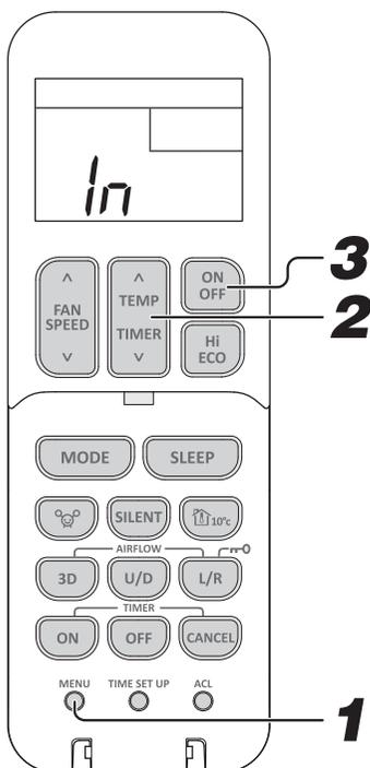
**1** Seleccione el Ajuste de comunicación de LAN inalámbrica pulsando el interruptor MENU (MENÚ).
