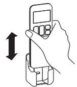
Para instalar o retirar el control remoto, deslice el mismo hacia arriba o hacia abajo desde la parte superior del soporte.
