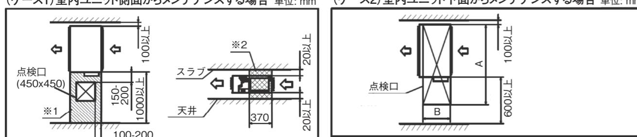
\* 1 ファンモータを側面へ引き出す構造となっております。障害になるものを設置しないでください。(印刷所)
