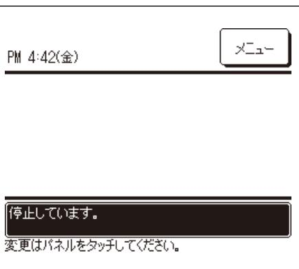
停止すると、画面上の各操作ボタンが消灯し、設定したバックライト点灯時間（☞29ページ）経過後、バックライトが消灯します。
