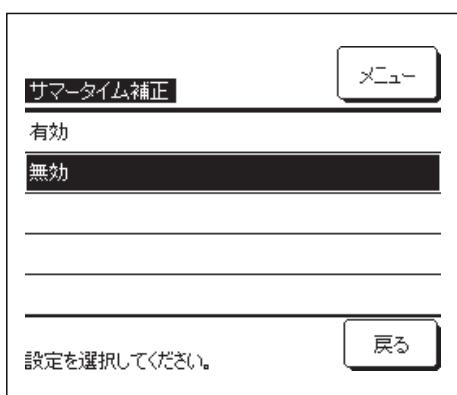
1 初期設定メニュー画面において、「サマータイム補正」をタッチすると、サマータイム補正設定画面を表示します。
