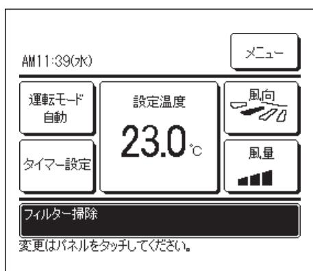
お掃除パネル接続ユニットにおいて、「ホコリを回収してください。」を表示した場合は、フィルターサインリセットを行っても、表示は消えません。ダストボックス内のホコリを回収し、ダスト回収リセットを行ってください。（☞51ページ）
