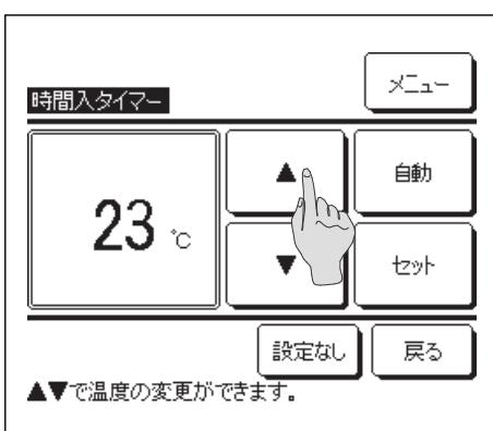
6 **▲** **▼**ボタンで、希望の設定温度（1°C単位）に合わせてください。あるいは**自動**ボタンをタッチし、設定温度自動を選択してください。
