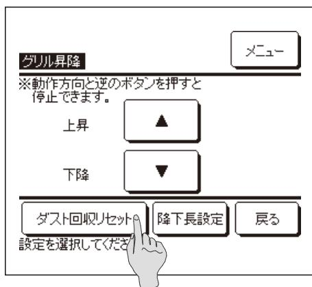
3 ダスト回収リセット確認画面を表示します。
