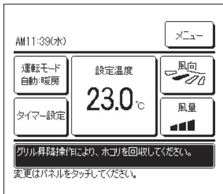
以下の操作により、ダストボックス内のホコリを回収し、「ホコリを回収してください。」表示を消してください。
