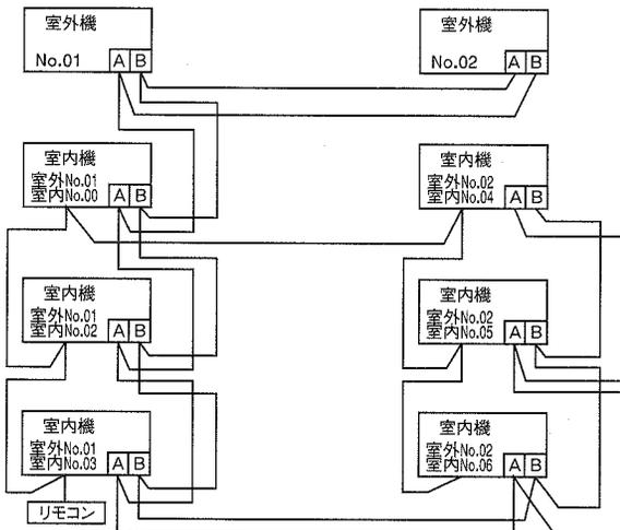
電源投入後、リモコンの**エアコンNo**を押すと室内機アドレスが表示されますので、▲▼ボタンで接続されている室内機アドレスがリモコンに表示されることを、必ず確認してください。
