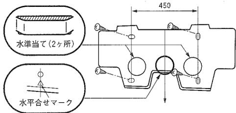
○据付板の水平調節は4本のねじを仮締めした状態で行います。
