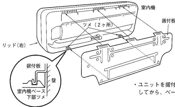
・ユニットを据付板から外す場合は、左右のリッドを外してから、ベース下部ツメを外してください。
