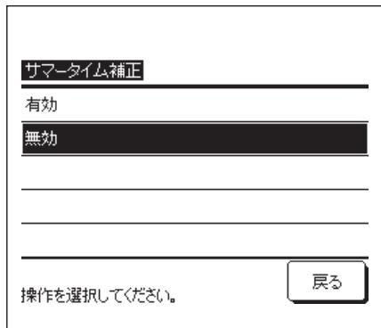
1 初期設定メニュー画面において、[サマータイム補正]ボタンをタッチすると、サマータイム補正設定画面を表示します。
