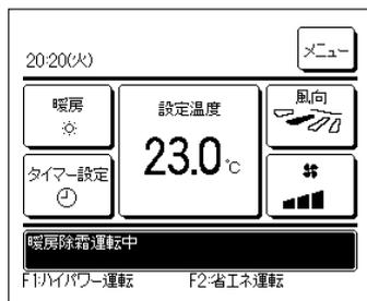
室外ユニットに霜が付くと暖房能力が低下するため、除霜運転に自動で切り換わり、室内ユニットからの温風の吹出しが止まります。メッセージ表示部には「暖房除霜運転中」を表示します。除霜運転完了後、「暖房除霜運転中」が消え、通常の暖房運転に切り換わります。
