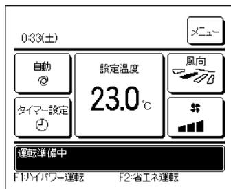
ブレーカ電源投入後の初回の運転、もしくは停電からの停電後の初回の運転において、リモコンに「運転準備中」表示が、最大で30分間表示される場合があります。圧縮機保護の為に冷凍機油保護制御が作動しており、故障ではありません。「運転準備中」表示が消えるまで、しばらくお待ちください。
