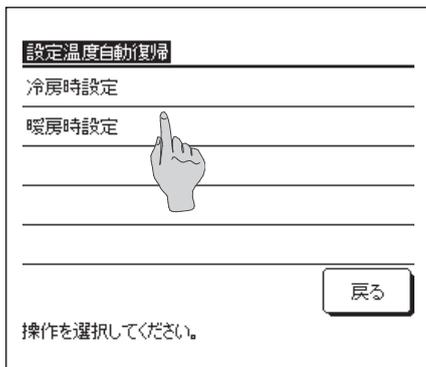
1 冷房時の設定を行う場合は、「冷房時設定」ボタンを、暖房時の設定を行う場合は、「暖房時設定」ボタンをタッチしてください。
