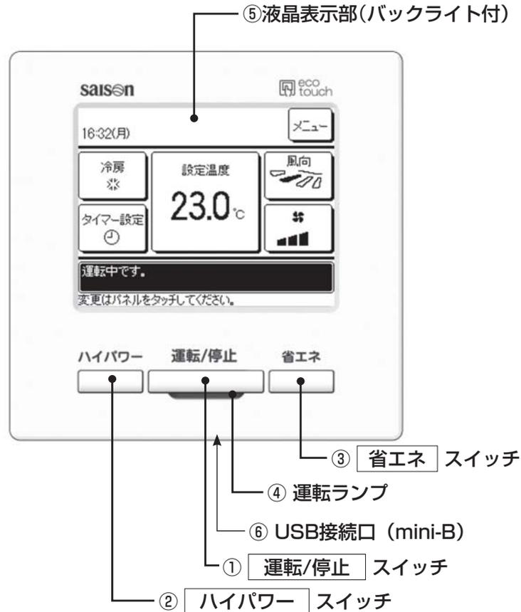
①運転/停止、②ハイパワー、③省エネ スイッチ以外の操作は、液晶表示部を指で押すタッチパネル方式となっています。
