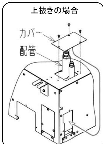
1. 右抜き又は上抜きの場合、外した板金カバーを背面穴に取り付けてください。
