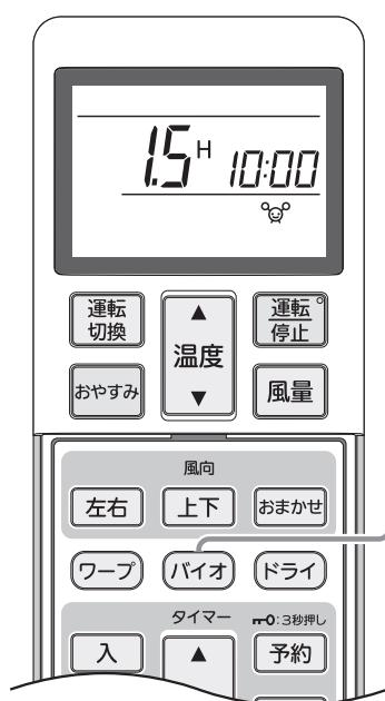
酵素の力でバイオクリアフィルター上に捕集したアレルギーの原因物質を分解する運転です。
