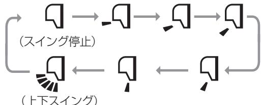
上下スイング中にスイングを停止した場合、停止した位置をマイコンが記憶します。次回運転時、フラップは前回と同じ位置にセットします。
