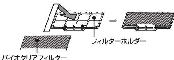
※バイオクリアフィルターはプリーツ（ひだ形状）が手前側になるように取り付けてください。
