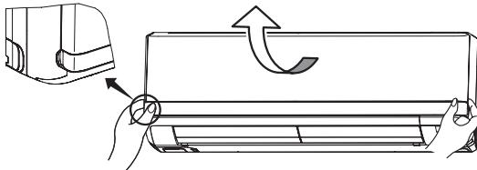
左右側面の凸部に手をかけ手前に引き上げると約60°開いた状態で静止します。それ以上引き上げるとパネルが外れることができます。注意してください。
