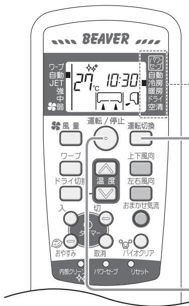
運転切換をしてから運転開始する場合は手順①から、運転切換をせずに運転開始する場合は手順②からの操作になります
