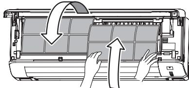
エアフィルターの両側を上図のように持ち、奥までしっかりと挿入します。エアフィルターなしで運転すると故障の原因になります。吸込パネルは左右そろえて軽く押したあと中央部を軽く押さえてください。
