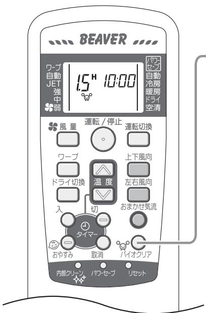
酵素の力でバイオクリアフィルター上に捕集したアレルギーの原因物質を分解する運転です。
