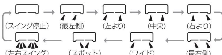
左右スイング中にスイングを停止した場合、停止した位置をマイコンが記憶します。次回運転時、ルーバーは前回と同じ位置にセットします。
