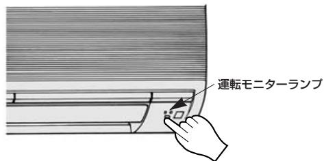
室内機の運転モニターランプを用いて運転内容を表示します。
