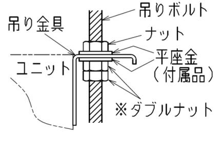
※ダブルナットで確実に固定してください。
