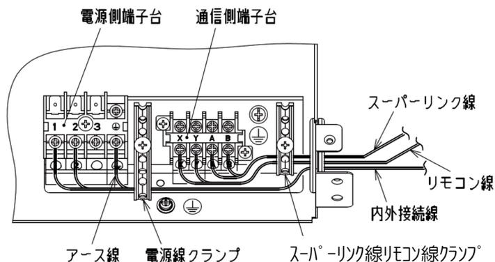
1. 冷媒配管穴から電源線をユニットに入れ板クランプを曲げて配線がたるみファンガードに接触しない様に固定してください。
