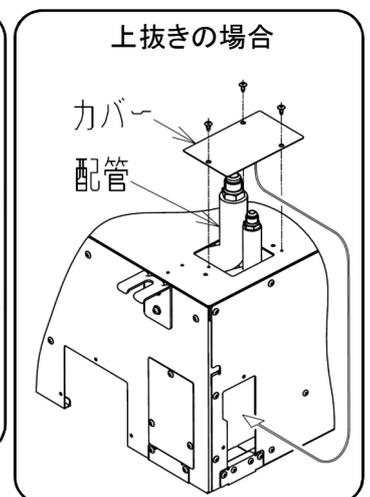
1. 右抜き又は上抜きの場合、外した板金カバーを背面穴に取り付けてください。
