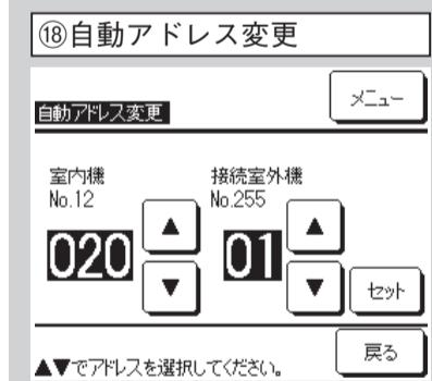
機外静圧補正機能付ダクト形室内ユニット組合せの場合に操作できます。
