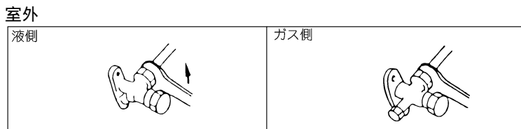
b 液側・ガス側共室外ユニットの接続口 A, B, C, Dにしっかりフレア接続してください。
