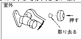
b フレアナットを外してください。 （液側・ガス側共）
