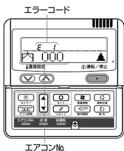
■エアコンに異常が起きるとエアコンが停止します。同時に点検表示灯が赤色で点滅し、入タイマー表示部にエラーコードが、表示部に下記の表示が出ます。
