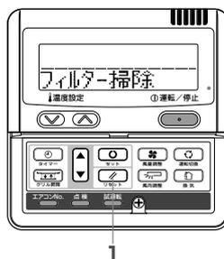
エアフィルタの清掃時期をお知らせするため室内機の延べ運転時間が設定時間に達すると「フィルター掃除」表示が出ます。
