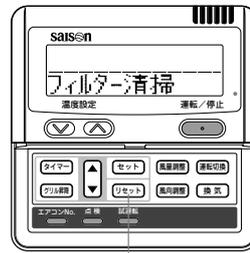
エアフィルタの清掃時期をお知らせするため室内ユニットの延べ運転時間が設定時間に達すると「フィルター清掃」表示が出ます。
