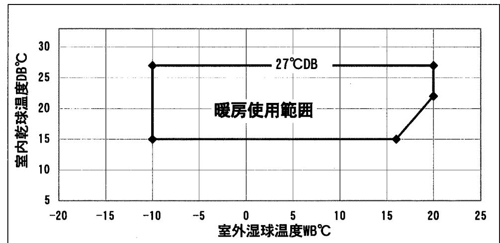
ユニットの風量を妨げる様な場所、室外ユニットに強風・他のユニット吹出風が当たる場所に設置された場合、冷房・暖房能力の減少、制御により連続運転をしない範囲が発生します。
