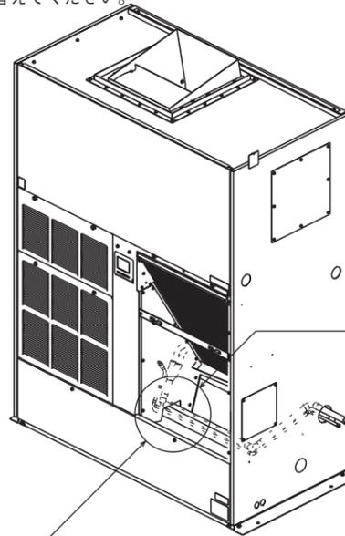
配管取り出し方向に合わせ切欠部のあるパッフルプレートを左右で付け替える
