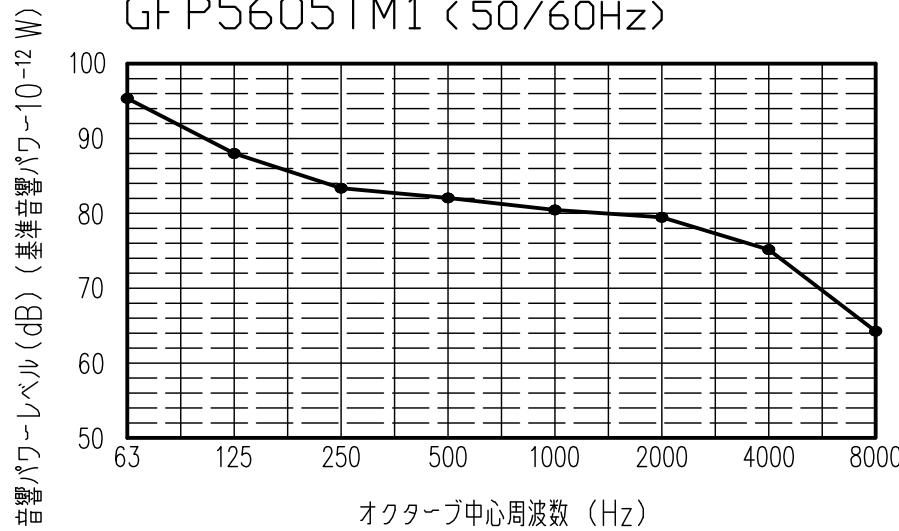
(注) 本図はオプション直吹チャンバー取付時の風量における運転音特性を示します。
