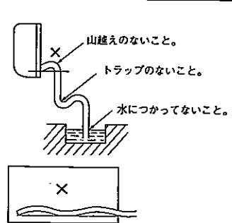
**注意** 確実に工事し、排水の確認をしてください。水漏れの原因になる恐れがあります。
