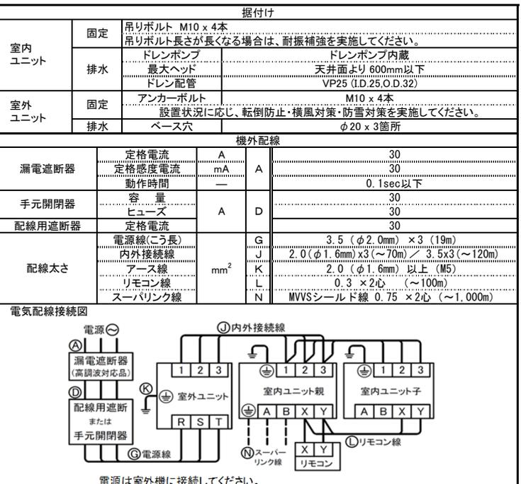
※ 固定部材、冷媒配管、ドレン配管、電源機器、各配線は、別売品をご利用いただくか、または現地手配してください。
