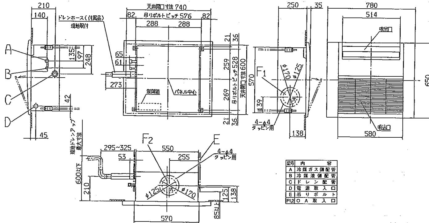
1. 所定の位置 (576×528) に吊りボルト (現地手配) を設置してください。
