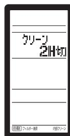
● 内部クリーン運転が設定されている場合は、AI自動快適、冷房およびドライ運転後に停止ボタンを押した後に自動的に内部クリーン運転を約2時間行います。
