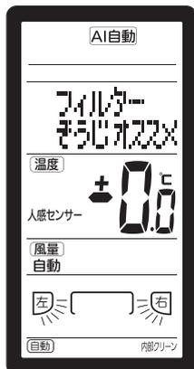
エアフィルターの清掃時期をお知らせするため、フィルター清掃設定が「切」で、**運転時間が延べ25時間**になるとリモコンに「フィルターそうじオススメ」を表示します。
