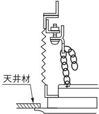
注) チェーンを引掛ける際は、パネル外枠を天井材にできるだけ密着させた状態でチェーンにたるみのないように行ってください。
