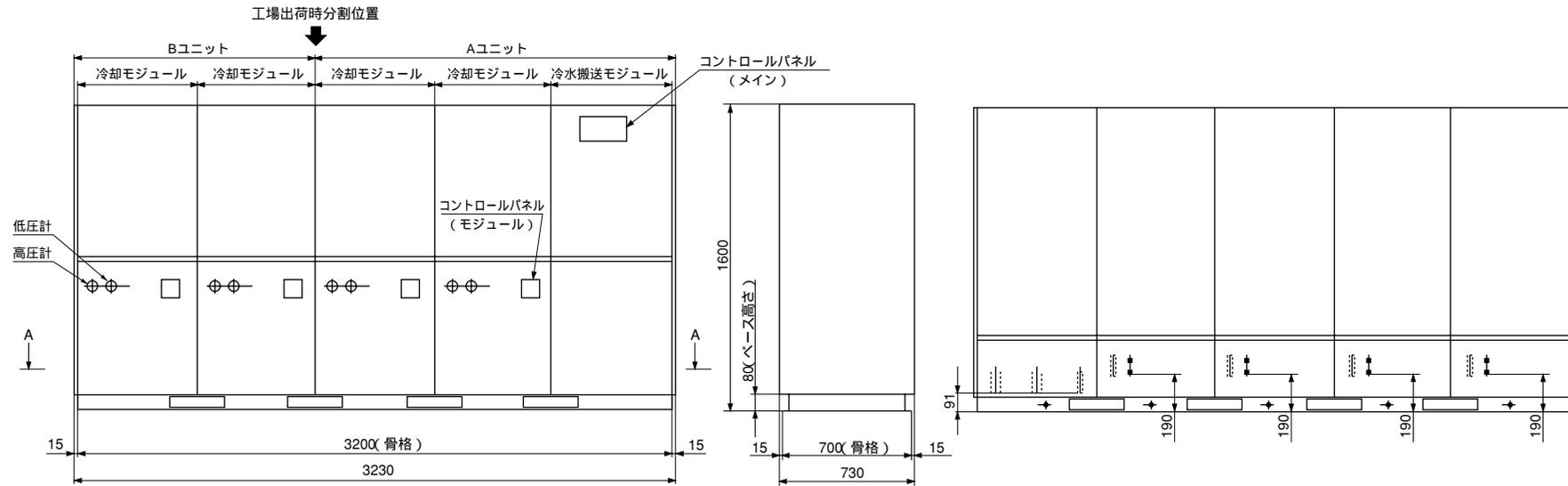
水・冷媒配管接続位置(配管底面抜の場合)
