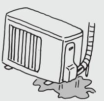
冷房時に、冷えた配管や配管接続部に水滴がつき、滴下するためです。暖房時に、霜取り運転でとけた水または水蒸氣が出るためです。暖房時に、熱交換器についた水が滴下するためです。故障ではありませんが、濡れてお困りの場合はお買上げの販売店へ排水工事のご相談をお願いします。なお一部寒冷地では室外機氷結のおそれがあり、工事ができない場合があります。
