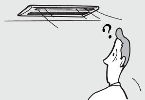
暖房運転時の吹出し空気温度が低いとき、または霜取運転中は自動的に水平吹出しになります。
