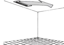
運転開始時、吹出し空気温度が低いとき、または霜取運転時は水平吹出しになります。
