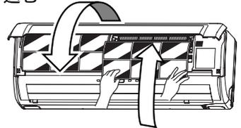
エアフィルターの両側を上図のように持ち、奥までしっかりと挿入します。エアフィルターなしで運転すると故障の原因になります。吸込パネルは左右そろえて軽く押ししてください。
