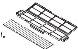
**4** フィルターを取り付けたフィルターホルダーをエアコン本体に差し込み、取付ける
