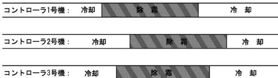
図7.8 個別運転制御方式個別除霜の動作
