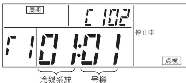
(1) 点検モード1の号機選択画面を表示します。
